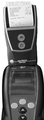
Zur Datenübertragung vom testo 324 an den IrDA-Protokolldrucker kann der Drucker in eine Ablage an der Oberseite des testo 324 gestellt werden.
